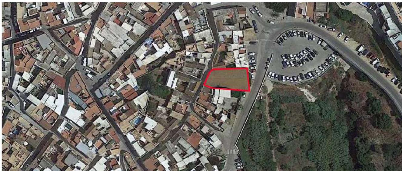
Planta poligonal irregular, con una superficie de 396 m<sup>2</sup>, según el levantamiento realizado. Edificación con una planta sobre rasante a C/ Sagasta y una a Plaza de la Paz, aunque en esta plaza, la planta se encuentra en una posición de planta primera. La planta baja es terreno.
