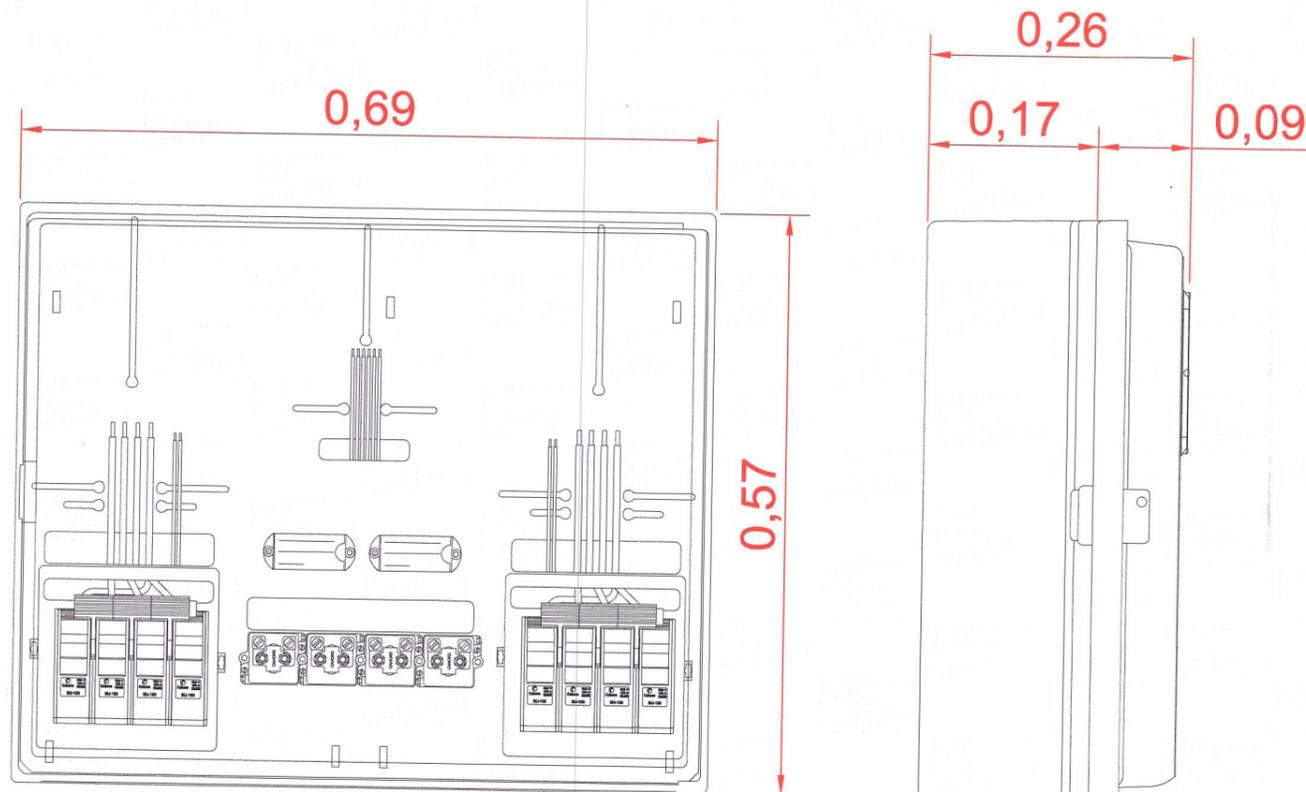
1. Conos elásticos para admisión de cables de fases y neutro tipo RV 0,6/1kV 1 x 240 mm<sup>2</sup> A
